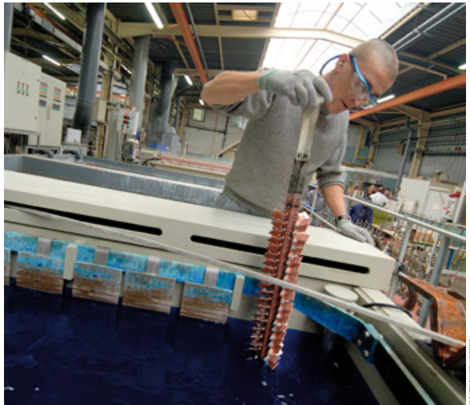
Trempe de pièces dans un bain de pyrophosphate de cuivre
